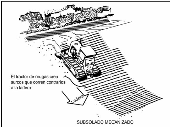
Ilustración 7. Subsulado de talud para facilitar germinación. Fuente: (Georgia Soil and Water Conservation Commission, 2005)
