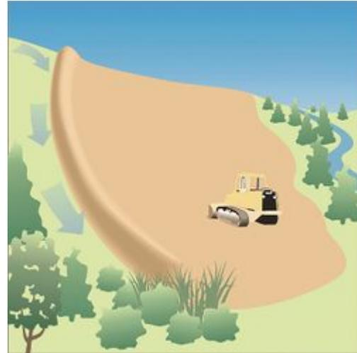
Ilustración 12. Berma de drenaje. Fuente: (Environmental Protection Agency [EPA], 2007)
